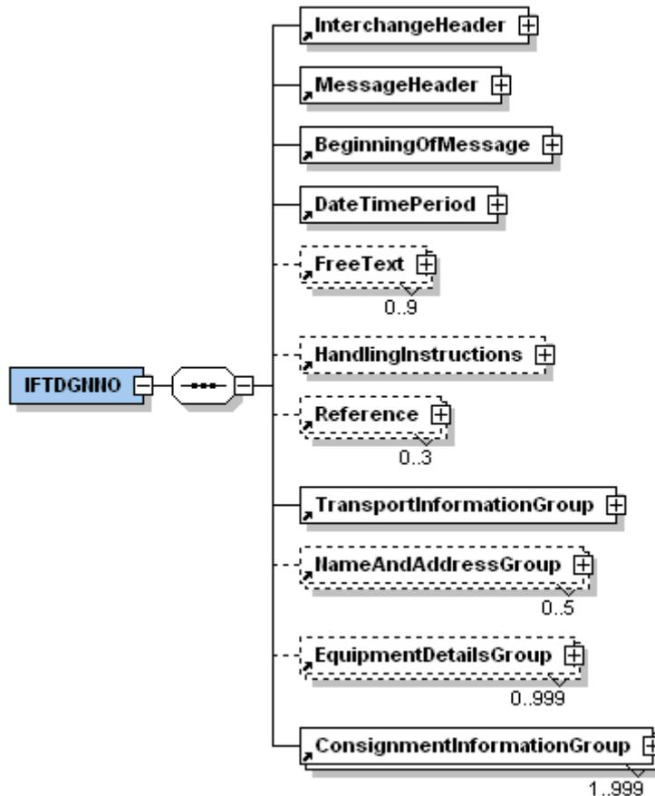
En los diagramas gráficos los recuadros punteados indican que la inclusión del elemento de datos simple, elemento de datos compuesto, grupo y/o grupo de elementos es Condicional (C), y los recuadros sólidos que es obligatoria (M) su inclusión en el mensaje. Nos referiremos a campos requeridos (R) para aquellos casos en que el estándar los admite como condicionales pero se requiere su inclusión en la presente definición de guía. Deben considerarse como obligatorios (M).
